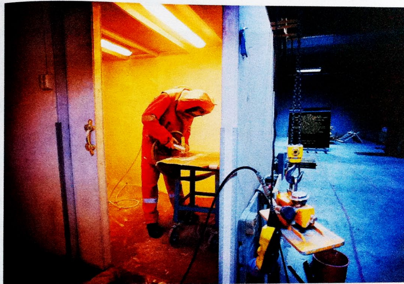
GRAVALVOR: Per Fronth sandblåser skriften på steinplatene iført maske hos et byrå som lager gravstøtter.
